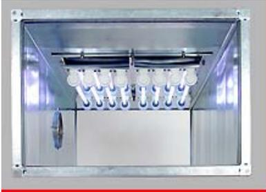
Moduli germicidi a flangia con lampada UV a media pressione a forte intensità da applicare negli impianti di condizionamento (HVAC), in particolare a valle delle U.T.A. (Unità di Trattamento Aria). Il tubo germicida a media pressione tipo HIG (High Intensity Germicidal) è in quarzo puro (ozon less o ozon free), con emissione a banda larga da 235 a 285 nm (nanometri).
